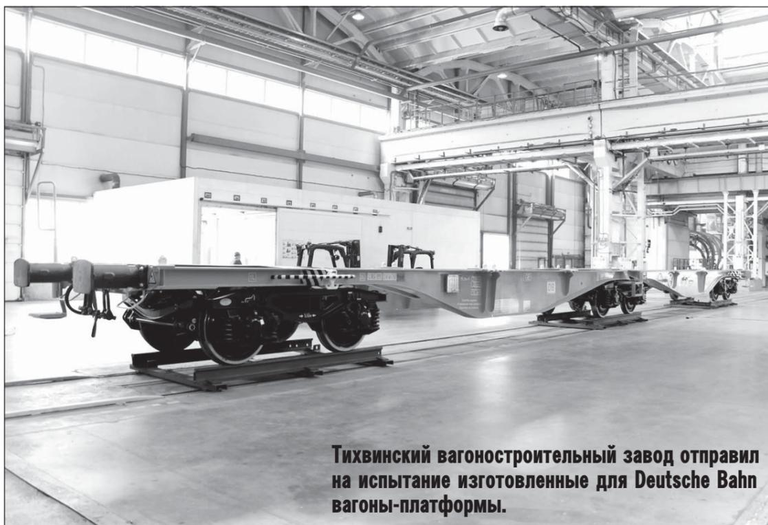
Тихвинский вагоностроительный завод отправил на испытание изготовленные для Deutsche Bahn вагоны-платформы.
